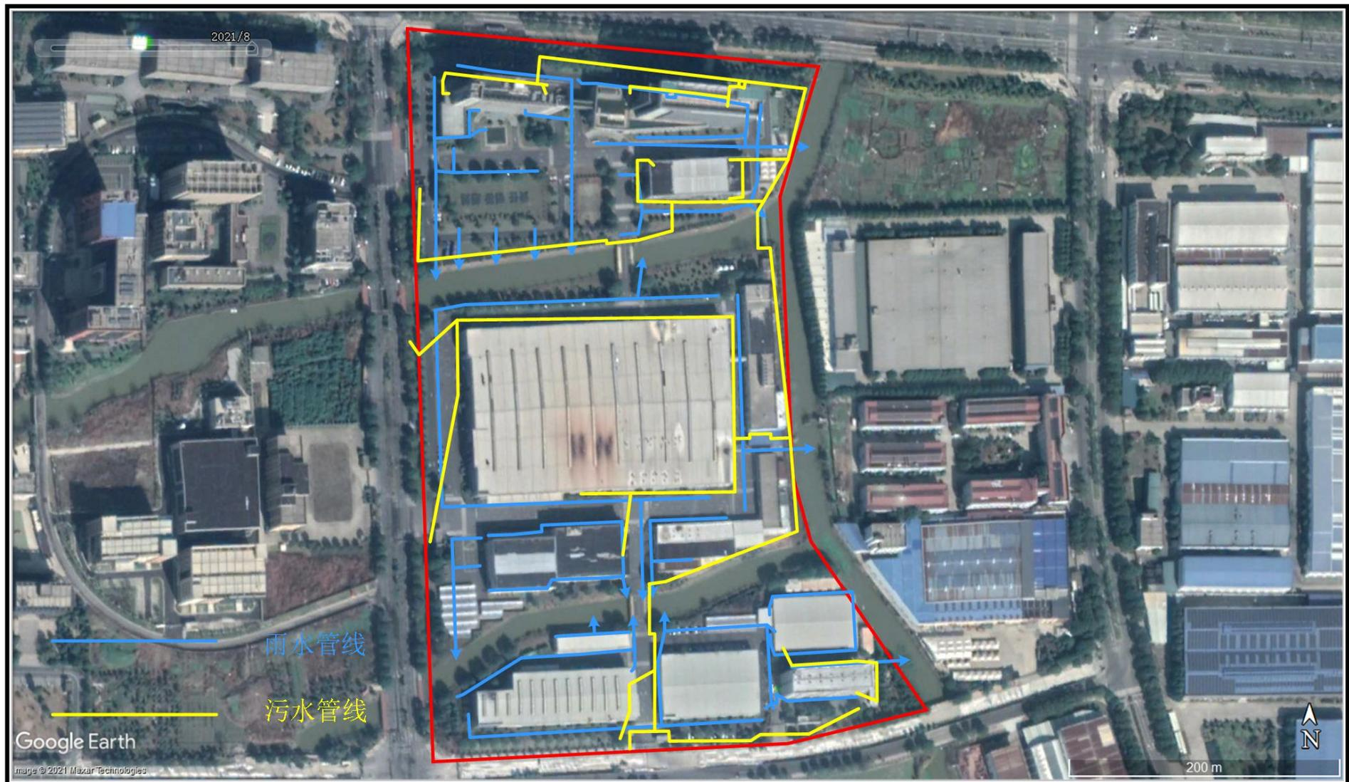
图2.5-12 雨污水管线图
