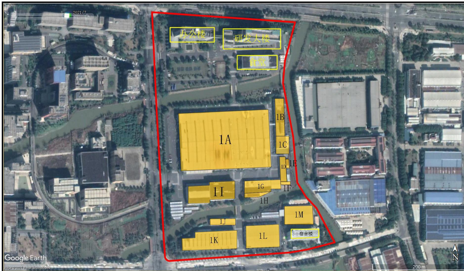
图 3-1 加西贝拉压缩机有限公司（亚中路厂区）地块疑似污染区域分布图
